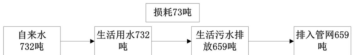
图3-3 本项目水平衡图
